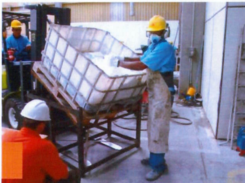
Figura 24 – Após implantação do suporte para melhoria da ergonomia
